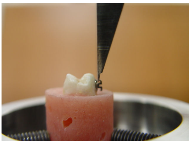
شکل ۲- محل قرارگیری تیغه دستگاه (محل اتصال وینگ به بیس براکت)
