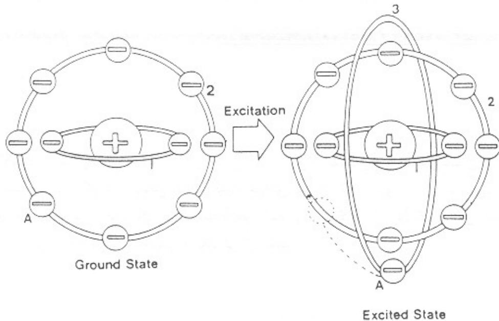
شکل ۱- یک اتم را در دو حالت سکون و تحریک شده می‌بینید توجه داشته باشید که در نتیجه تحریک، یک الکترون از یک مدار پائین‌تر به یک مدار بالاتر که دارای سطح انرژی بیشتری است صعود می‌باید.
