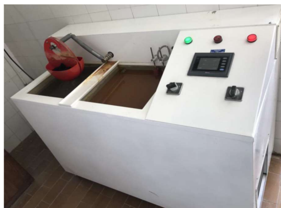
شکل ۲- دستگاه ترموسایکلینگ به منظور اعمال سیکل حرارتی بر روی نمونه‌ها
