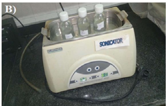
شکل ۱- حل کردن نانو ذرات در محلول مونومر به وسیله مگنت استیرر (A) و سونیکاتور (B)
