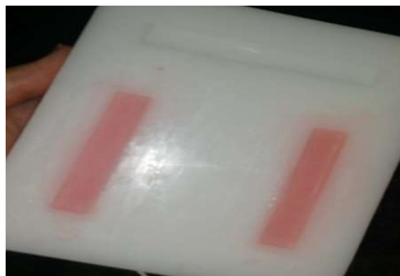
شکل ۲- تهیه وکس آپ مومی از بیس تفلون با ابعاد ۶۷ \times ۱۲ \times ۲/۶ میلی متر
