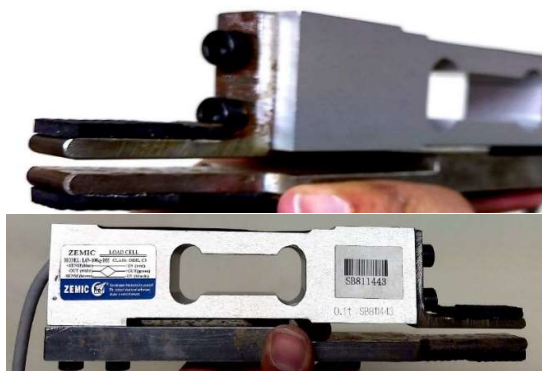
شکل ۱- دستگاه ثبت نیروی بایت
