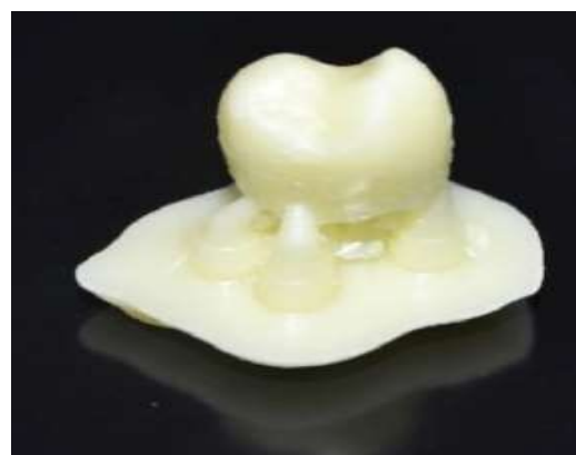
شکل ۱۰- روکش موقت چاپ شده توسط چاپگر سه بعدی قبل از حذف مواد پشتیبان و پرداخت (۴۹)
