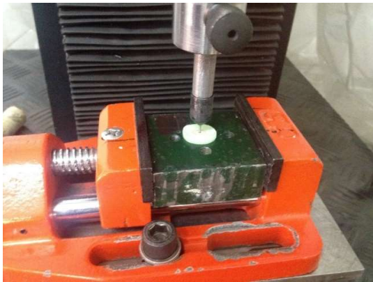
شکل ۱- قرارگیری نمونه‌ها در دستگاه تست یونیورسال
