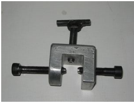
شکل ۳- گیره مخصوص نگهداری بیس آکریلی
