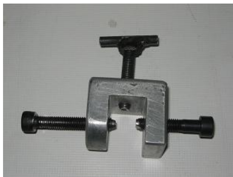
شکل ۳- گیره مخصوص نگهداری بیس آکریلی
