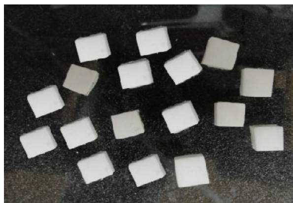
شکل ۱- بلوک‌های پیش‌ساخته سینتر شده از دو نوع کور زیرکونیایی سفید رنگ
