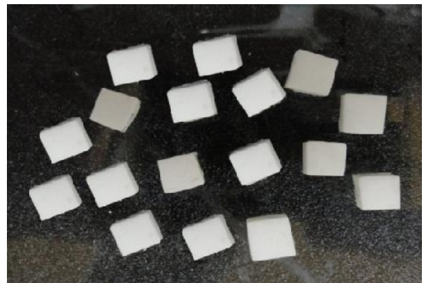
شکل ۱- بلوک‌های پیش‌ساخته سینتر شده از دو نوع کور زیرکونیایی سفید رنگ
