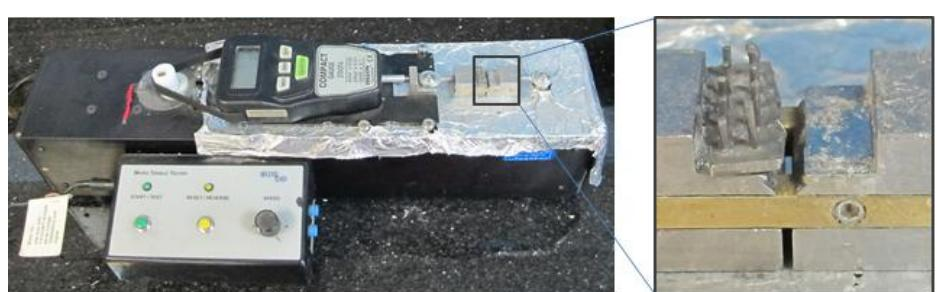
شکل ۱ - تصویر دستگاه Micro-tensile tester و استوانه‌های فلزی لحیم شده به فک دستگاه
