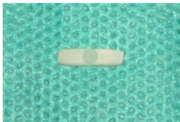
شکل ۲- نمونه‌های بعد از برش به صورت میله‌هایی بودند که کور کامپوزیتی در دو طرف و پست در مرکز قرار دارد.
