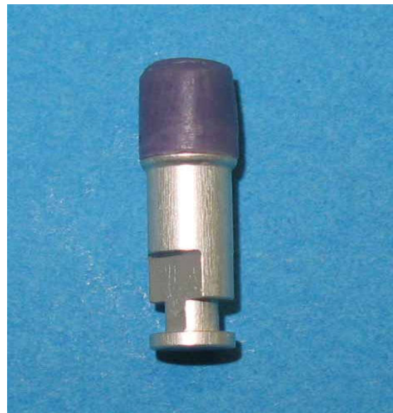
شکل ۲- مدل مومی finish شده روی مدل آزمایشی
