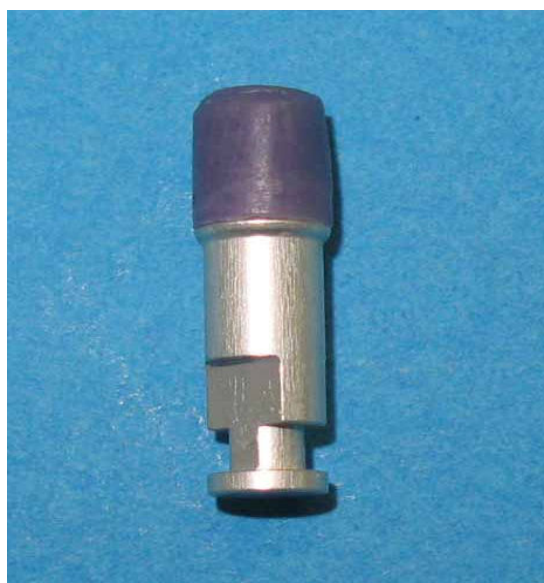
شکل ۲- مدل مومی finish شده روی مدل آزمایشی
