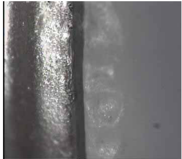
شکل ۴- تصویر تهیه شده از لبه کور و مدل آزمایشی توسط استریومیکروسکوپ
