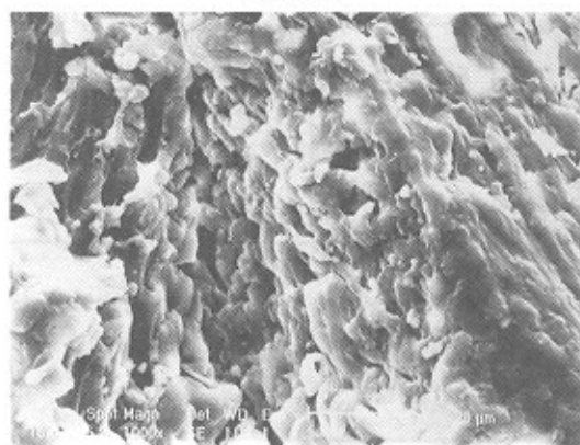
تصویر ۳- نمایی از مخلوط رزین آکریلی با ذرات Al_2O_3 (بزرگنمایی ۱۰۰۰ برابر)
