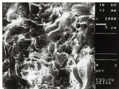
شکل ۵- فتومیکروگراف سطح پرسن اچ شده با APF ۱/۲۳٪ به مدت ۱۰ دقیقه (بزرگنمایی ۲۰۰۰ برابر)
