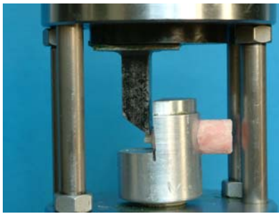
شکل ۲- نحوه ورود نیرو بر نمونه کامپوزیت- پرسن
