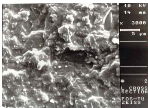
شکل ۲- نمای SEM از سطح شکست کامپوزیت لوسیت
