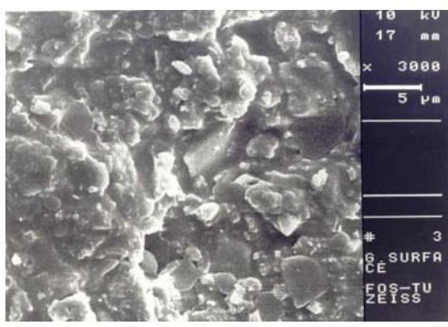
شکل ۵- نمای SEM از سطح سایش کامپوزیت شیشه
