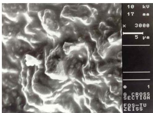
شکل ۴- نمای SEM از سطح شکست کامپوزیت شیشه
