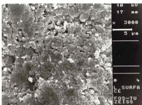
شکل ۳- نمای SEM از سطح سایش کامپوزیت لوسیت
