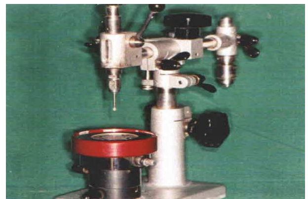
شکل ۲- دستگاه موازی‌ساز جهت پانچ نمونه‌ها
