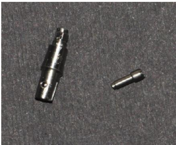
شکل ۴- شکست پیچ اباتمنت در گروه تیتانیومی پیش ساخته
