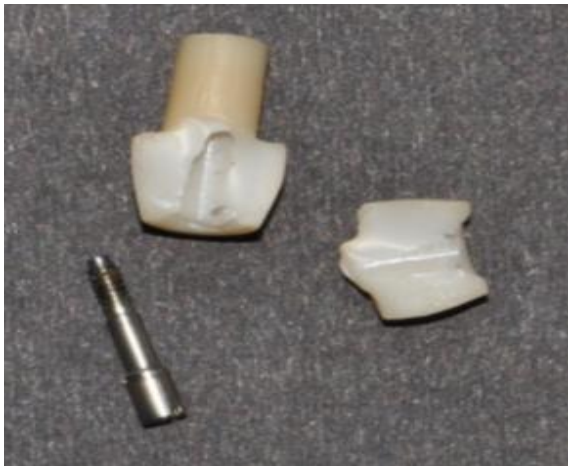
شکل ۳- شکست ناحیه اتصال در گروه Copy-milled
