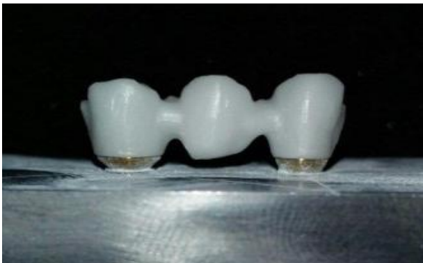
شکل ۲- یکی از فریم ورک زیرکونیای بر روی مدل اصلی
