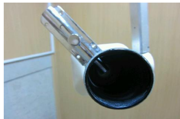
شکل ۳- تصویر کشوی رفت و برگشت نشانگر لیزری
