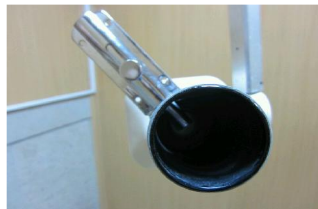
شکل ۳- تصویر کشوی رفت و برگشت نشانگر لیزری
