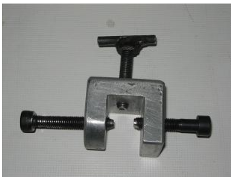
شکل ۳- گیره مخصوص نگهداری بیس آکریلی
