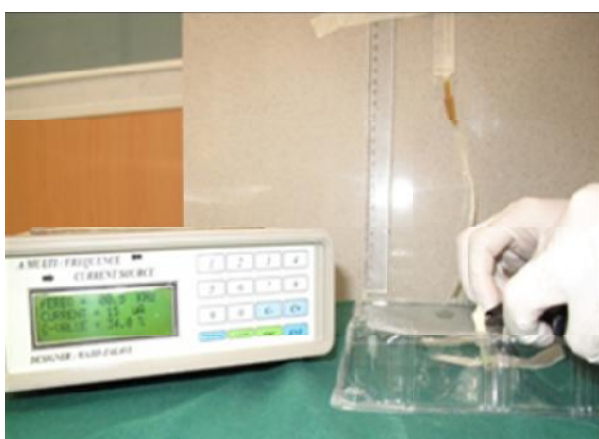
شکل ۲- ایجاد فشار پالپی و مراحل انجام کار
