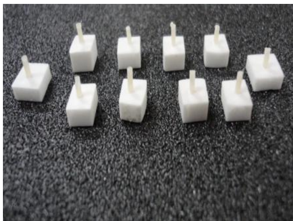
شکل ۳- استوانه‌های کامپوزیتی به سطح سرامیک باند شده است
