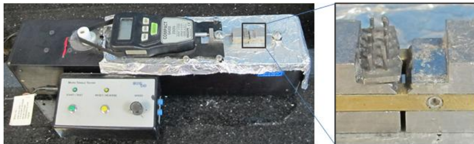
شکل ۱- تصویر دستگاه Micro-tensile tester و استوانه‌های فلزی لحیم شده به فک دستگاه
