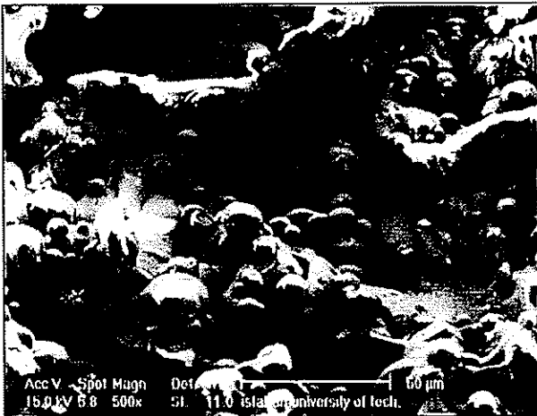
تصویر شماره ۲- میکروگراف سطح پوشش هیدروکسی آپاتیت پاشش پلاسمایی شده که با میکروسکوپ الکترونی روبشی تهیه شده و نشانگر ساختار ذوب شده همراه با اندکی ریز ترک و تخلخل است.
