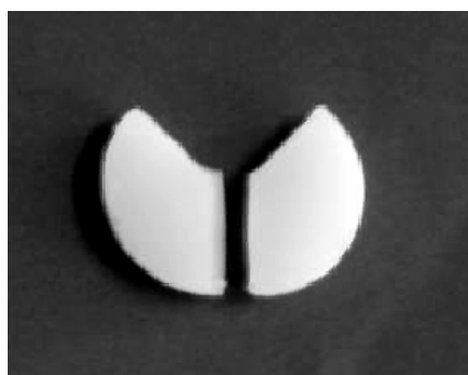
شکل ۵- نحوه شکست نمونه‌ها
