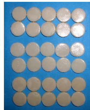
شکل ۴- نمونه‌های آماده شده پس از سیمان کردن لامینیت با پس‌زمینه
