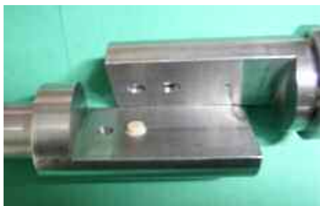
شکل ۱- نمایی از Jig از پیش طراحی شده نمونه‌های سرامیکی جهت انجام تست برشی
