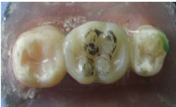
شکل ۸- سائیدگی سطح اکلوژال پونتیک اینله بریج خلفی پس از انجام عمل load cycling
