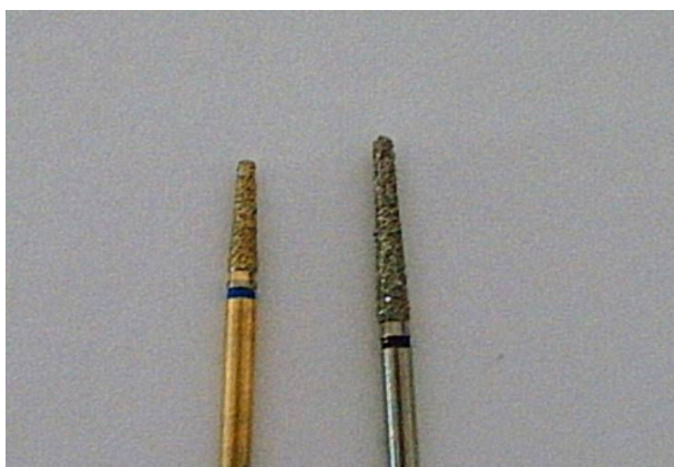
شکل ۱- فرز Depth cut در اندازه 0/3 ، 0/5 و 0/7
