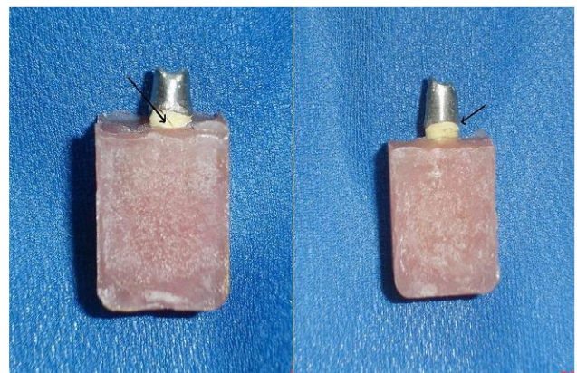
شکل ۴- الف: شکست کور در گروه بدون فرول شکل ب: شکست مایل ریشه در گروه با فرول
