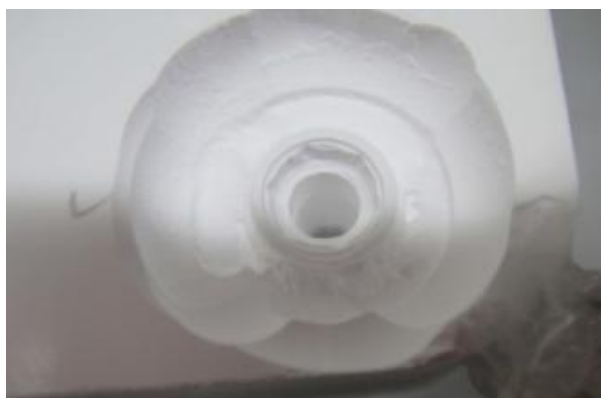
شکل ۱- ساخت نمونه‌های Copy-milled با استفاده از بلوک‌های زیر کونیایی
