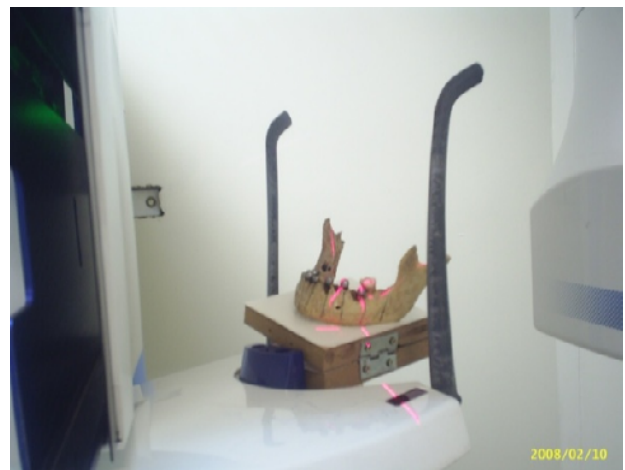
شکل ۲- تنظیم زاویه قرارگیری پلن مندیبل به کمک دستگاه طراحی شده
