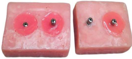
شکل ۲- بلوک‌های آکریلی تهیه شدند به طوری که ایمپلنت‌ها در عمق‌های مختلف آن قرار گرفته‌اند.
