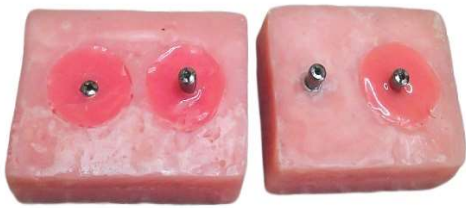
شکل ۲- بلوک‌های آکرلیکی تهیه شدند به طوری که ایمپلنت‌ها در عمق‌های مختلف آن قرار گرفته‌اند.
