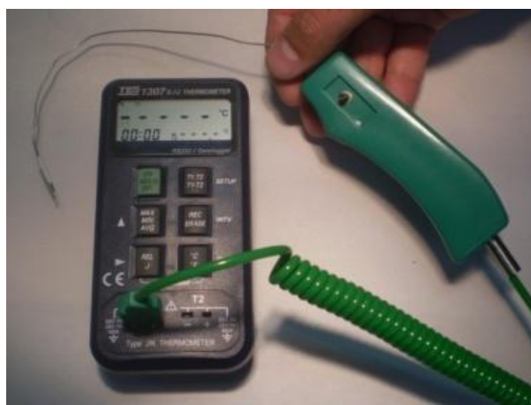
شکل ۱- دستگاه ترمومتر TES مدل 1307 Datalogging Thermometer و ترمومترهای استاندارد از نوع J-type
