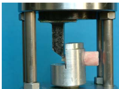
شکل ۲- نحوه ورود نیرو بر نمونه کامپوزیت- پرسن
