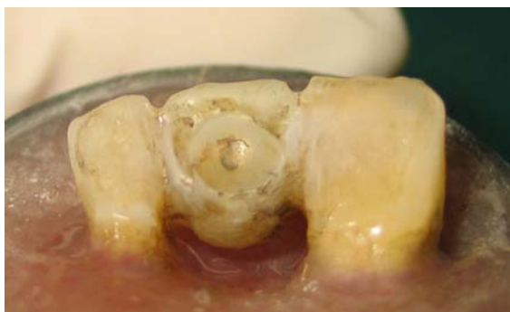
شکل ۹- ساییدگی سطح لینگوال پونتیک اینله بریج قدامی پس از انجام عمل load cycling
